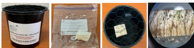
Figure 2 : Piège pondoir et ses composants (saut, grille métallique, bloc de polystyrène, larvicide biologique).
